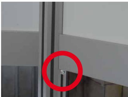
Schieben Sie die Mutter in die Nut des Ständers bis unter die Zarge und drehen Sie die Schraube unter der Zarge fest.
